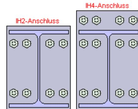
Analog zu den Anschlussgeometrien mit zwei Schrauben je Schraubenreihe werden die äquivalenten T-Stummel für vier Schrauben je Reihe gebildet.
