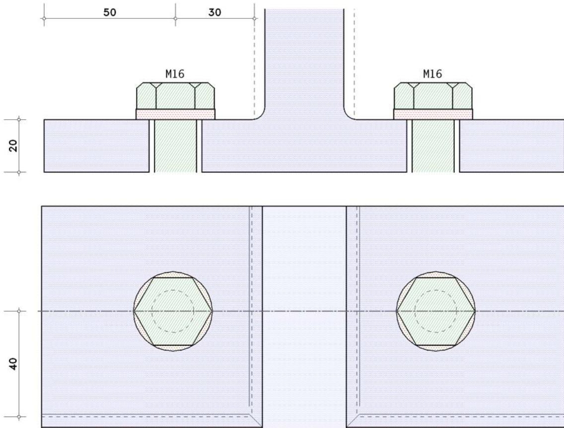
**T-Stummelflansch** mit Dicke  $t_f = 20.0$  mm, Stahlgüte S235
