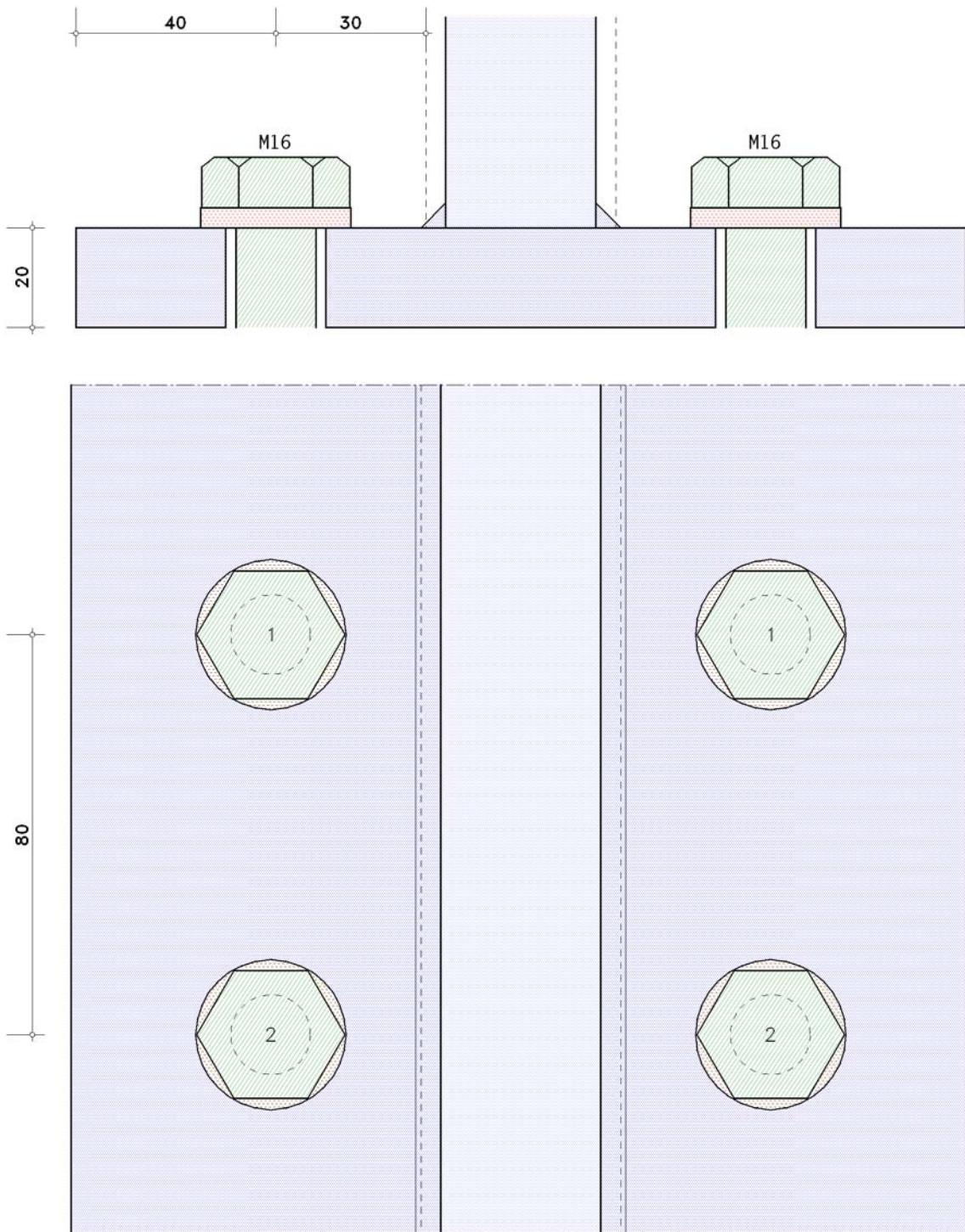
**T-Stummelflansch** mit Dicke  $t_f = 20.0$  mm, Stahlgüte S235
