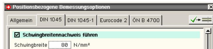
Abb. 42: objektbezogene Bemessungsangaben DIN 1045 - Schwingbreitennachweis
