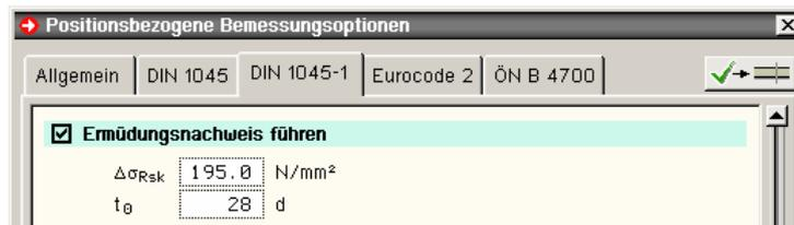
Abb. 27: objektbezogene Bemessungsangaben DIN 1045-1 - Ermüdungsnachweis
