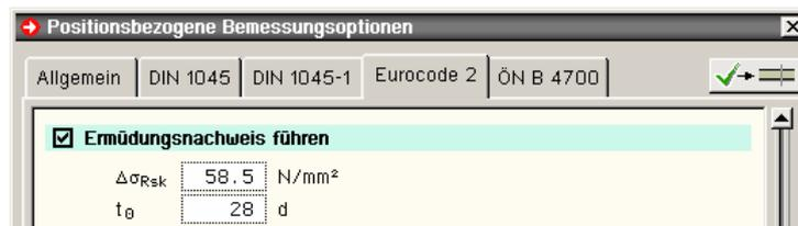
Abb. 12: objektbezogene Bemessungsangaben Ermüdungsnachweis n. EC 2
