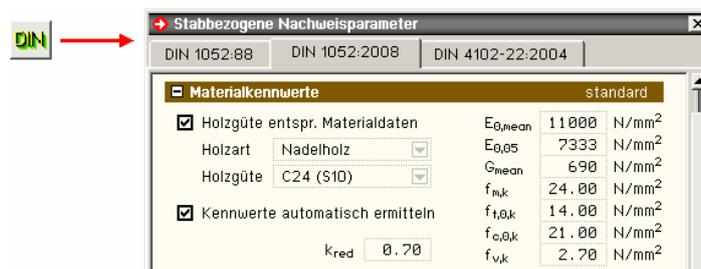
Abb. 51: Stabbezogene Nachweisparameter: Materialkennwerte
