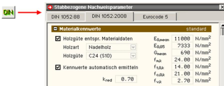
Unter der Überschrift *Materialkennwerte* im zweiten Register des Eigenschaftsblatts können die Materialeigenschaften für den durchzuführenden Nachweis sowie die Festigkeitskennwerte (auf charakteristischem Niveau) festgelegt werden.
