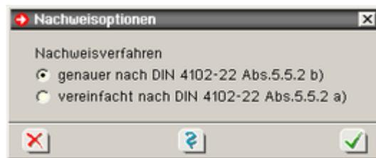
Mit dem Brandschutznachweis soll sichergestellt werden, dass das Tragwerk auch im Brandfalle eine gewisse vorgebbare Zeit tragfähig bleibt, um Personen im Gebäude eine geregelte Räumung zu ermöglichen.
