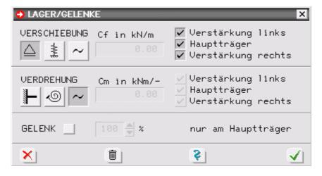
Die Wahl der Lagerbedingung für Verschiebung und Verdrehung erfolgt über die Optionsschalter. Bei elastischer Lagerung wird das entsprechende Eingabefeld für die Federsteifigkeit freigeschaltet.
